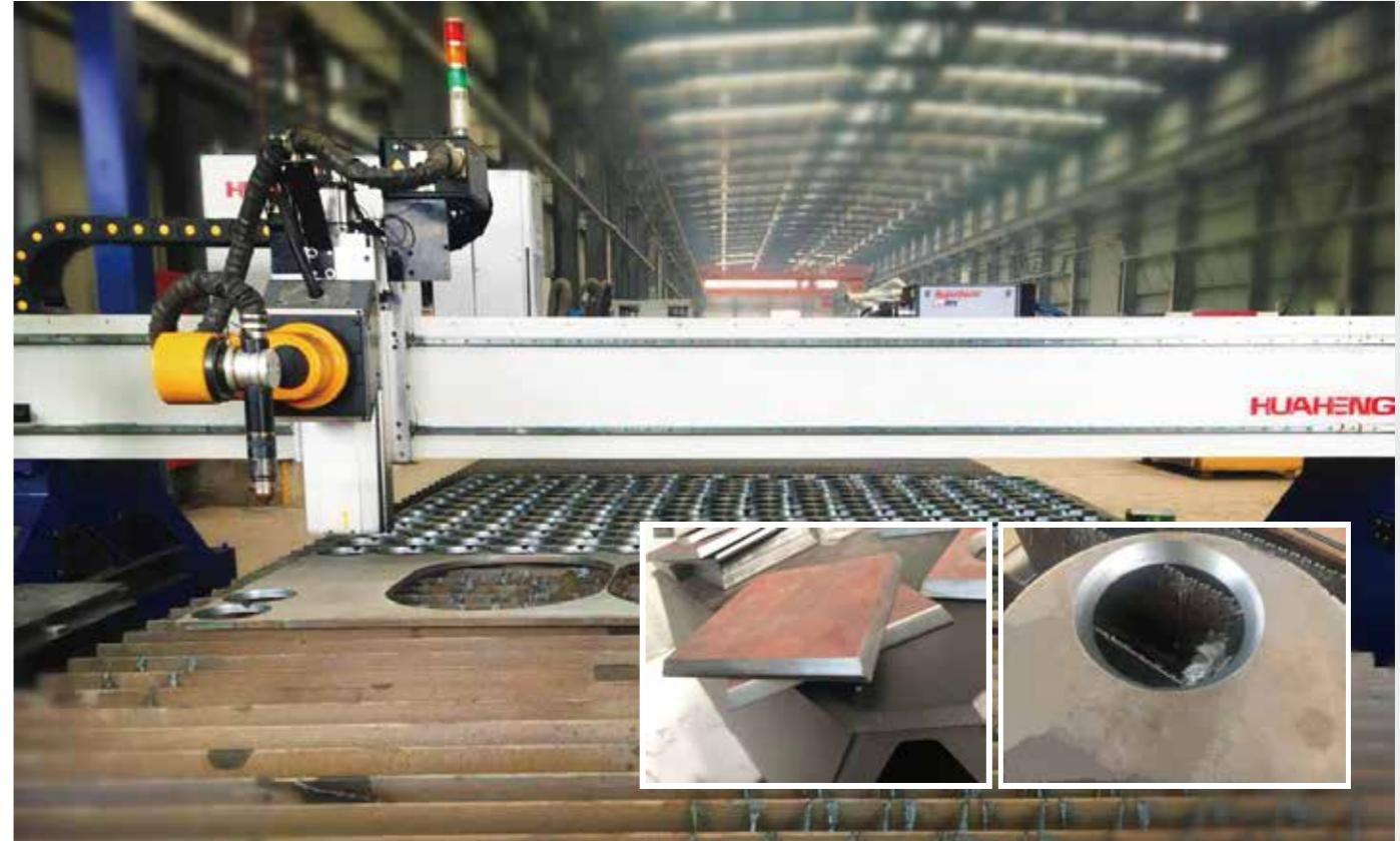
• ProCut Bevel 采用进口二轴回转头，整机实现五轴联动。回转头具有零点消间隙装置与防碰撞功能，水平方向工作旋转角度达±50°，可以进行V、Y、I等各型坡口切割。
