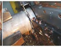
● 大管径端面坡口 + 内镗全CNC控制切削工艺
