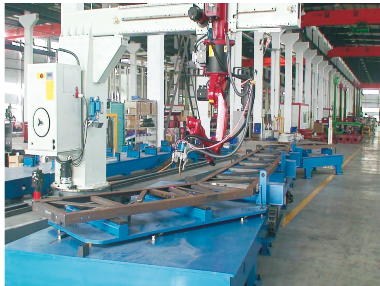
桁架智能焊接
