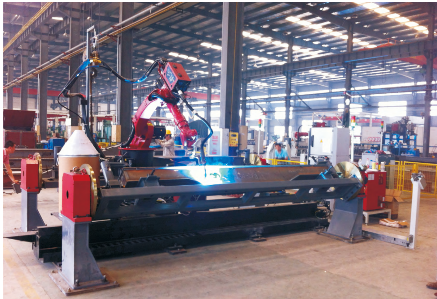
侧梁机器人焊接
