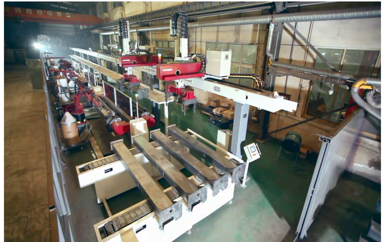
汽车举升机生产线
