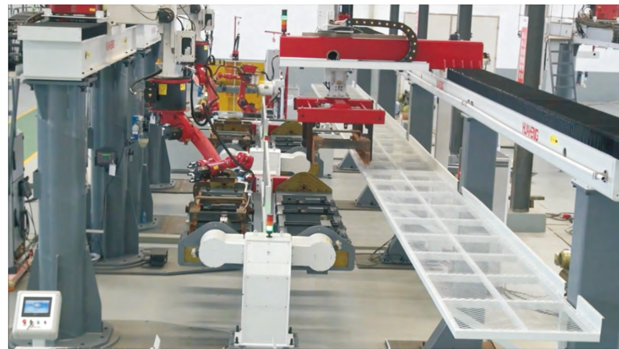
叉车门架生产线
