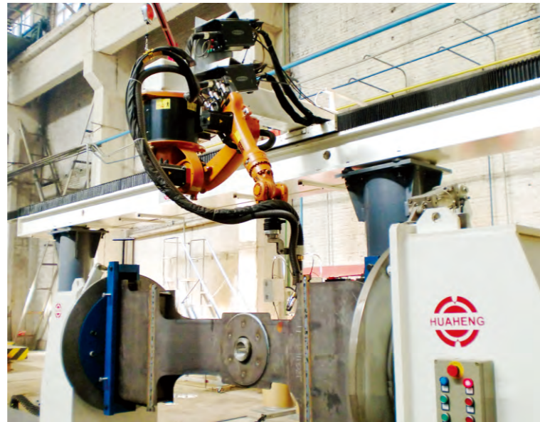
构架梁机器人焊接
