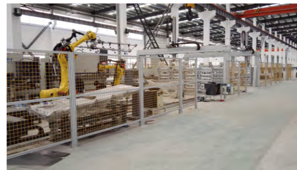
电梯门板全自动生产线
